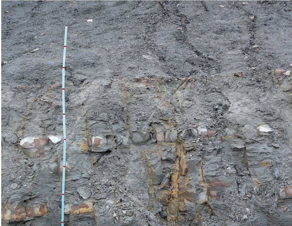
Abb. 7: Kösten A73: Die Mergelsteine sind noch bergfarben grau. Nur eine Kluft rechts von der Bildmitte hat Saprolitspuren. Maßstab 1,60 m, jeder Abschnitt 20 cm. Bei 60 cm von unten endet die oberste Heinach-Kalksteinbank. Knapp über 100 cm liegt die Hummendorf-Lage als Grenze des hellgrauen Übergangsmergels gegen den dunkelgrauen Amaltheenmergelton. Diese Grenze ist die Amaltheenton-Diskordanz. Photo: W. SCHIRMER 25.11.2006.
