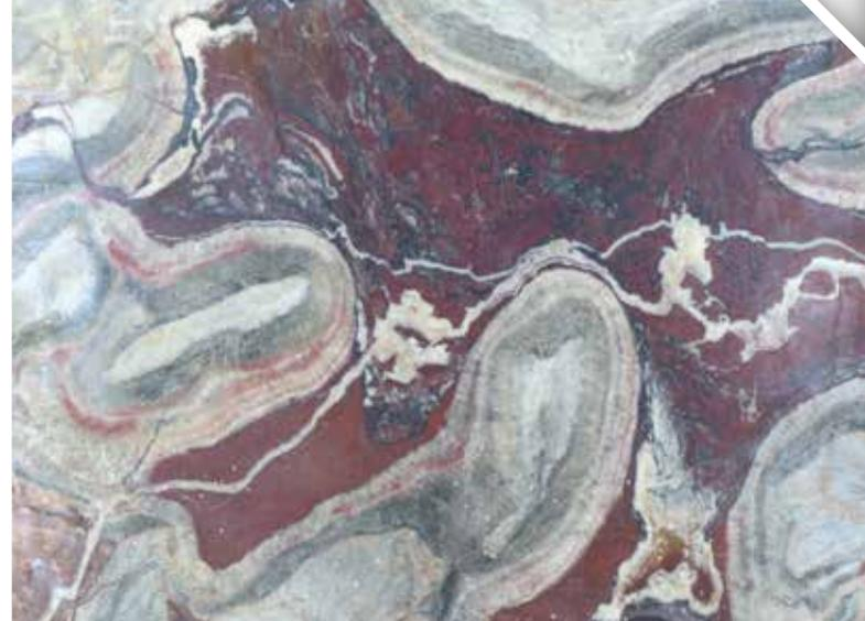
Bild 4: Katzenellenbogener Devon-Kalkstein (rotbraun) mit Anschnitten von Stromatoporen-Kolonien (hell) an einem der Sockel der Säulen im Gartensaal der Residenz - Fotos: Wolfgang Schirmer
