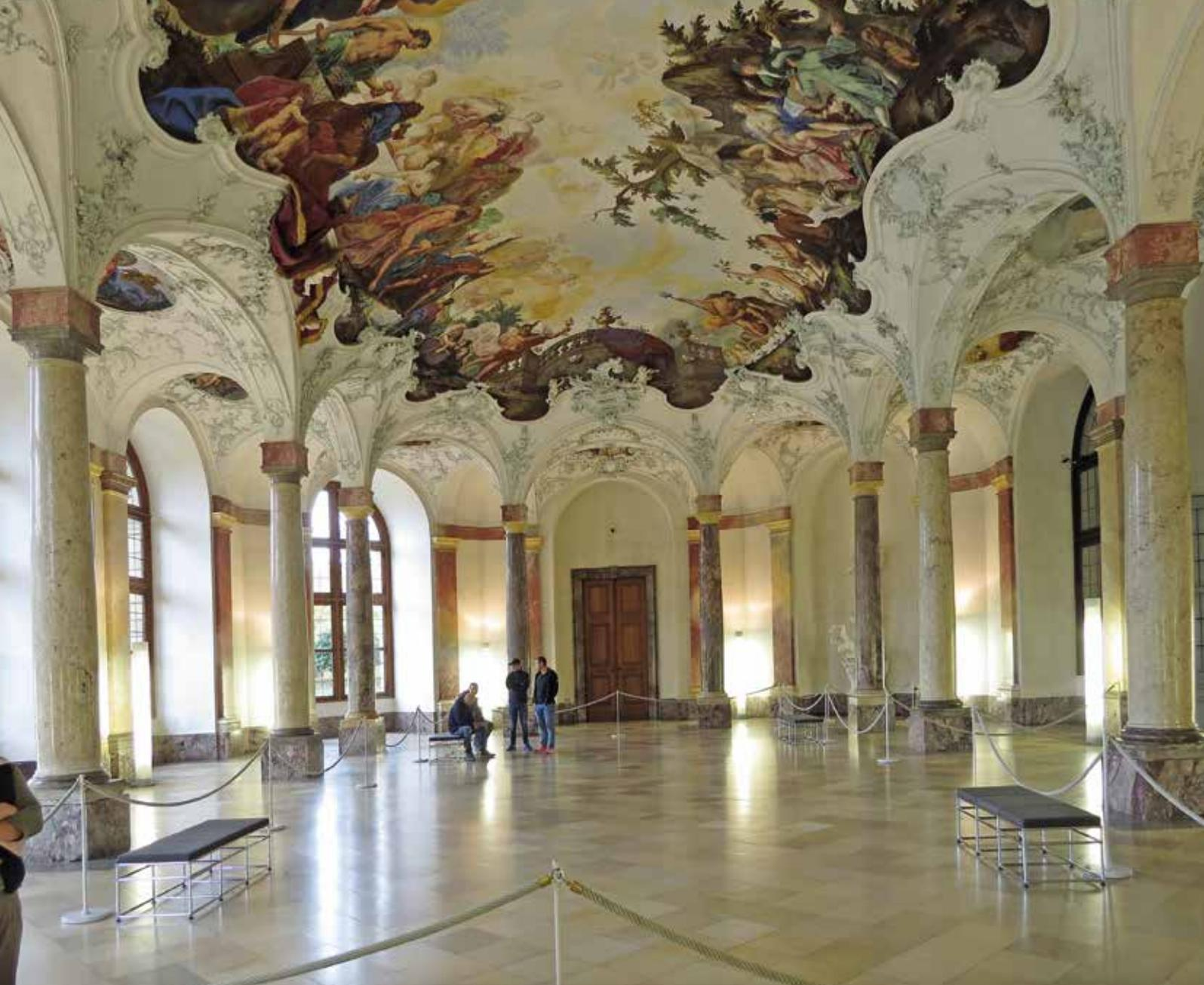
**Bild 1:** Gartensaal der Würzburger Residenz mit vier der zwölf Säulen aus Weißjura-Kalkstein der Neideck im Vordergrund und vier aus Devon-Kalkstein von Katzenellenbogen an der Lahn im Hintergrund · Foto: Wolfgang Schirmer
