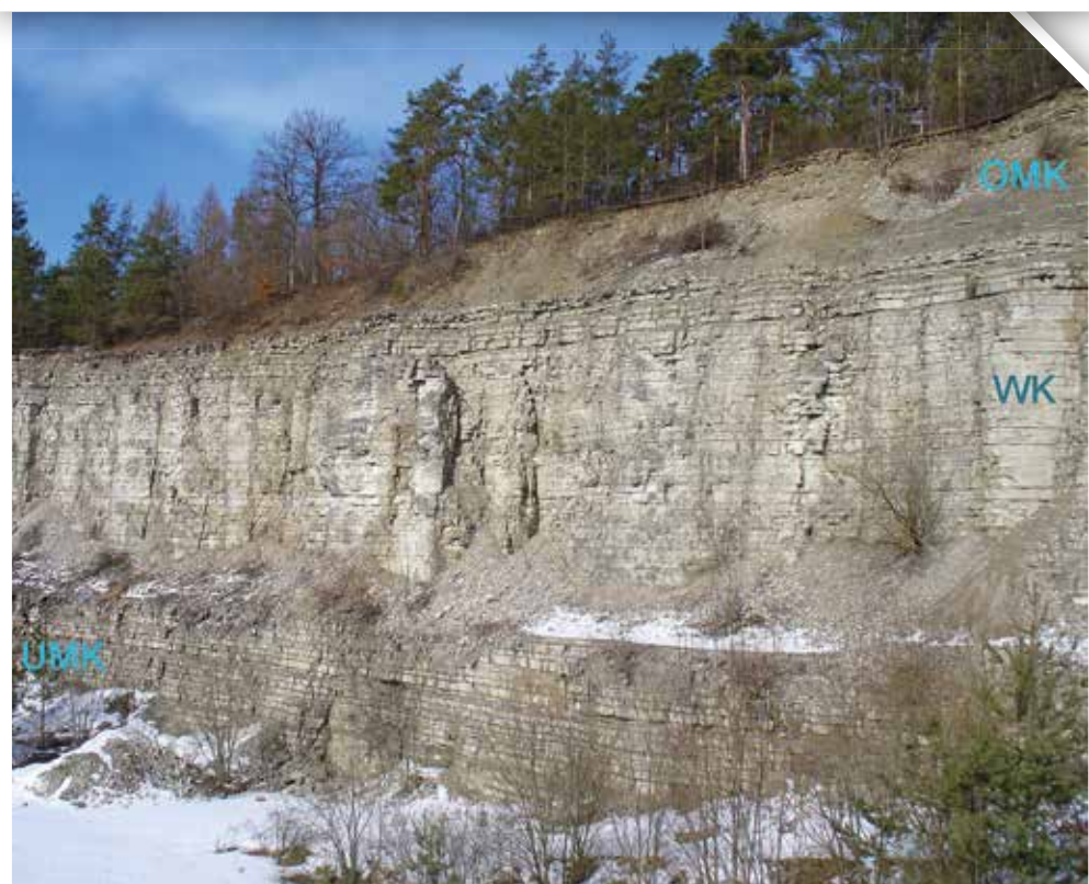
Bild 6: Unterer Mergelkalkstein (UMK), Werkkalkstein (WK) und Oberer Mergelkalkstein (OMK) im Steinbruch Einbühl/Ebermann- stadt. Das Bild zeigt deutlich, dass der Werkkalkstein, wie sein Name sagt, den besten Baustein darstellt. Foto: 19. Februar 2006
