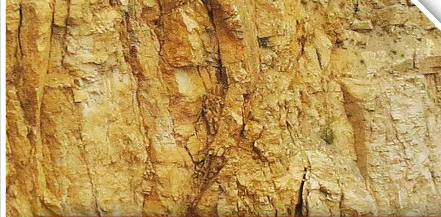
**Bild ②:** Engständige Klüftung im Kalkstein des Weißen Juras. Die Klüfte sind geschlossen, zeigen aber schon etwas Verwitterung. Steinbruch Pilgerndorf (2018).
