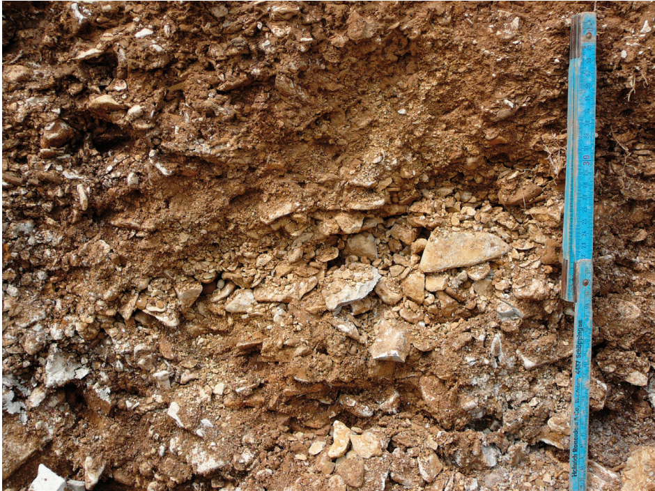
Abb. 6. Ausschnitt aus dem Flussbettsediment der Nassanger-Terrasse im Aufschluss Wannbach einige Meter talwärts vom Profil Wannbach 1. In der Bildmitte ist eine Partie von Skelettschotter sichtbar, umgeben von matrixgestütztem Schotter. Foto: W. Schirmer 14.05.2007
